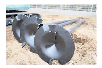
パーフェクトプレス工法(以下、本工法と略す)は、鋼管にハットウィング工法(GBRC 性能証明 第 15-17 号 改 2)に用いる、切り込み加工した凹型鋼板を取り付けた先端翼付き鋼管を補強材とし、基礎スラブ底原地盤の 支持力にこの地盤補強材の支持力を複合させることで、小規模建築物のべた基礎に要求される支持力を確保する ものです。
